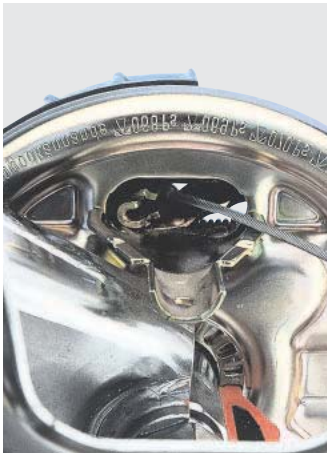
El cable bowden se fija en la argolla de freno, ahorrando tiempo de montaje.
