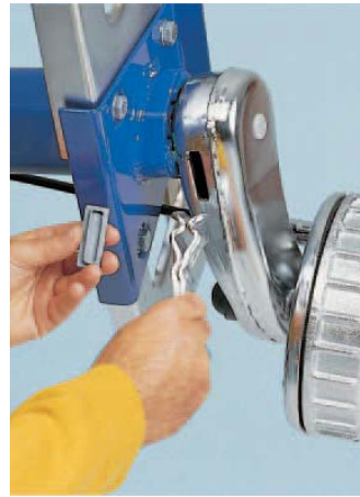
Soporte amortiguador encajable para un montaje posterior más sencillo.
