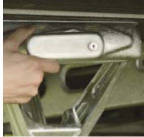
Encajar el Safety en la ranura y empujar hacía la derecha
